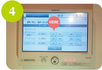
4 設定切替の「運転」をタップします
