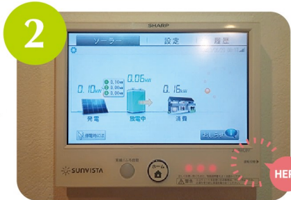
2 右側面の「運転切替」を押します
